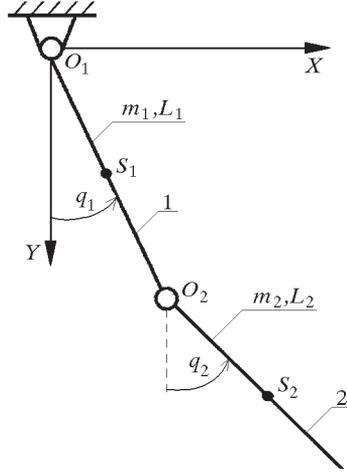
Fig. 1. Double pendulum
