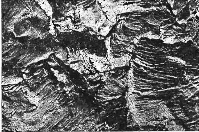
Rys. 8. Przykład licznych miejscowych zagnieceń powierzchni pęknięcia w stali 20G2ANbY przy R = -1 , \sigma_a = 275 \text{ MN/m}^2 , L = 10,3 \text{ mm} , N = 1,8 \cdot 10^5 .
